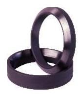
Соединительные кольца, изготовленные из углеродного графита, в основном, используются во вращающихся соединениях для ввода пара, воды или газов во вращающемся оборудовании, например, в роликах или цилиндрах. Функцией данных колец является уплотнение и в то же время компенсация вибраций и объемного расширения при вращении.
